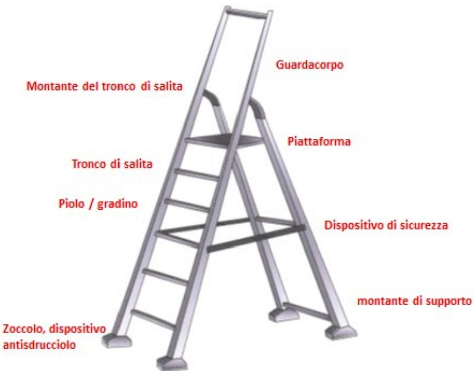
**Sul mercato sono reperibili vari modelli di scale che rappresentano indubbiamente la categoria di scale più frequentemente utilizzate, caratterizzate da una altezza inferiore ai 5 metri. La scala doppia può essere provvista di una piattaforma e di un guardacorpo.**
